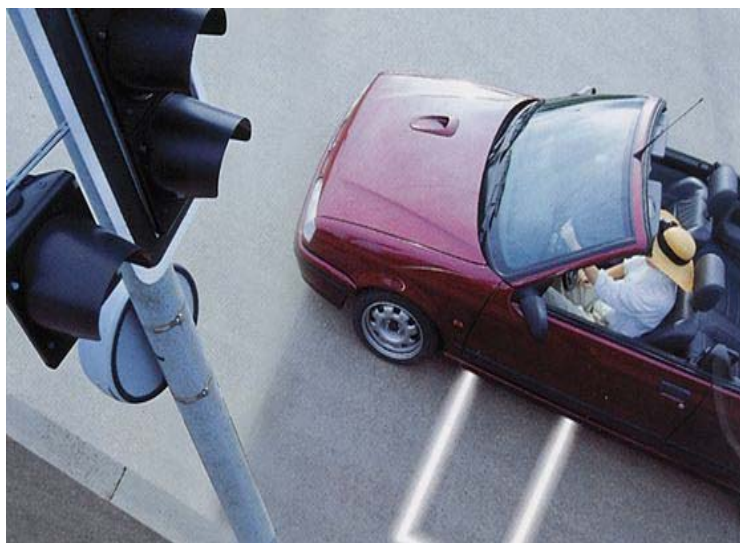
Figura 16 - Exemplo de aplicação do loop indutivo (representado pela faixa branca sobre o solo).
