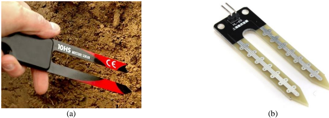
Figura 1. Sensores de umidade do solo: (a) industrial, fornecido com folha de dados
